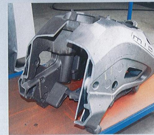
L'usinage intégral de la coque se fait sur machine à commande numérique à cinq axes : précision et fini sont irréprochables.
