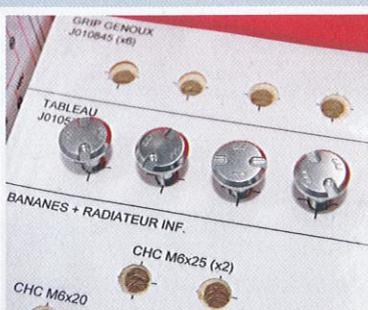
Vis Midual en alliage léger aéronautique 7075 résistance 58 kg/mm<sup>2</sup> pour, notamment, grippé-genoux et tableau de bord. La tête est marquée M et une clé spéciale est fournie.
