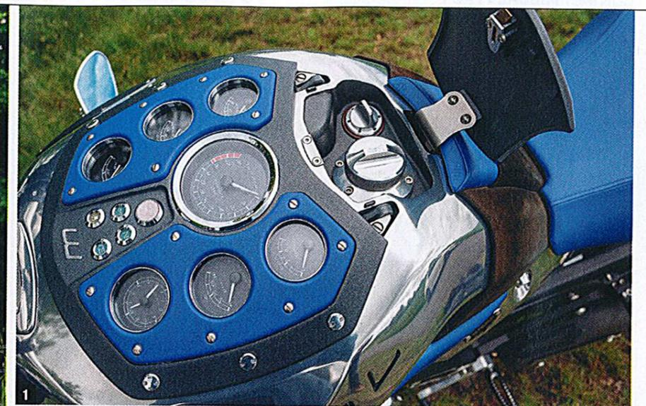
**1** Outre le compteur lisible et bien placé, le tableau de bord à 7 cadrans, digne des plus belles montres, affiche les températures d'huile et d'eau, la pression d'huile, une jauge à essence, un voltmètre, un compte-tours et une montre. La trappe permet d'accéder aux bouchons d'huile et d'essence.
