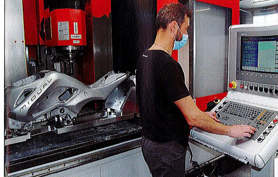
L'usinage intégral de la coque se fait sur machine à commande numérique à cinq axes : précision et fini sont irréprochables.
