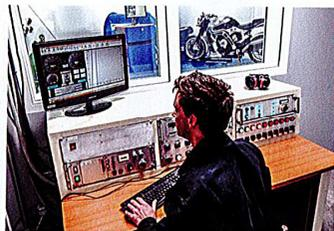
Un banc moteur permet le développement et valide le montage du bicylindre.
