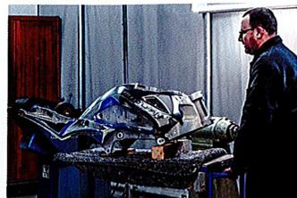
La mono-coque accueille le réservoir de 14 litres. Affichant 80 kg, sortie de fonderie, après usinage, elle ne pèse plus que 24 kg.
